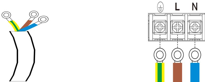
**警告：**为满足安全要求，使用的负载电线始终要足以承载电源的最大短路输出电流而不会发生过热。如果有多个负载，则每对负载电线都必须能够安全承载电源的满载额定电流。
